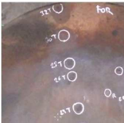
Einbau in der Kolbenoberfläche eines Schiffsdieselmotors und Temperaturverlauf während eines Zyklus an den verschiedenen Messpunkten
