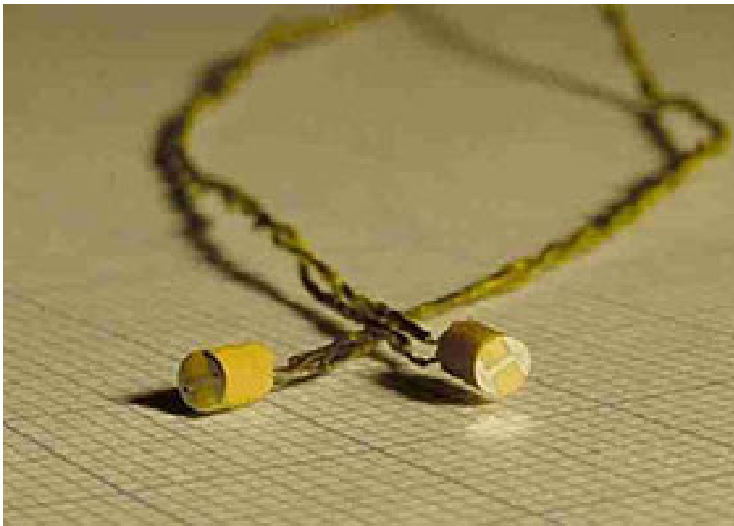
Dünnsfilm-Sonden mit Anschlussdrähten und Kabeln
