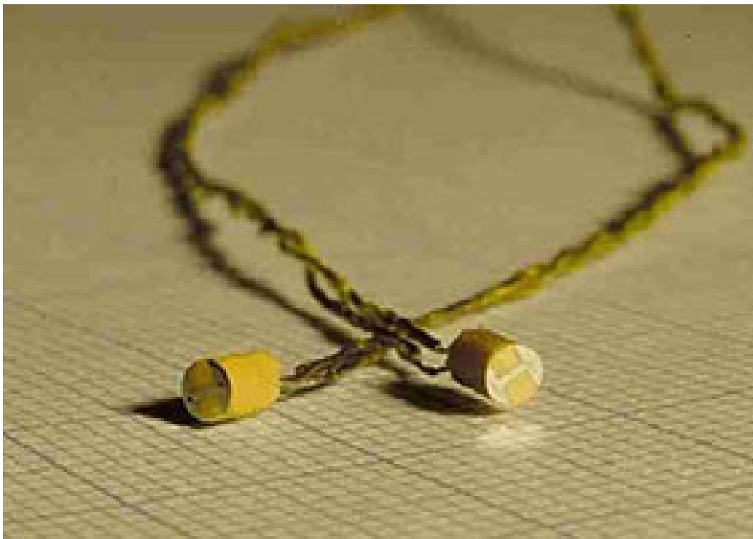
Dünnsfilm-Sonden mit Anschlussdrähten und Kabeln
