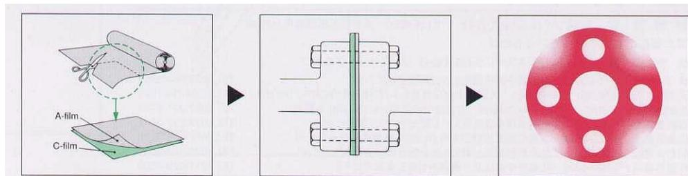
Die Druckmessfolien werden als 1- oder 2-lagige Folien hergestellt. Bei den 2-lagigen Typen sind auf der einen Messfolie Mikrokapseln aufgebracht, auf der anderen Folie befindet sich eine Entwicklerschicht.
