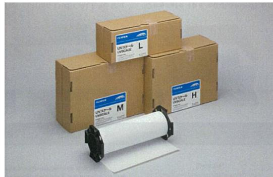
Die UV-Licht-Messfolie kann ähnlich leicht wie die Wärme- oder Druckmessfolie verwendet werden. Mit der Schere zurechtgeschnitten wird sie auf die zu prüfenden Körper gelegt. Innerhalb der Folie befinden sich Mikrokapseln mit Farbe und Entwickler, die auf die Belastung hin reagieren und die Folie verfärben. Die Intensität der Verfärbung ist proportional zur Höhe der UV-Lichtdosis.
